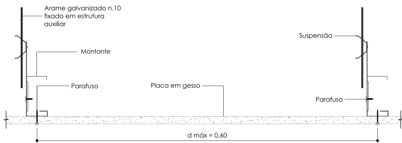
Forro monolítico - Detalhe Genérico Corte transversal Sem escala
